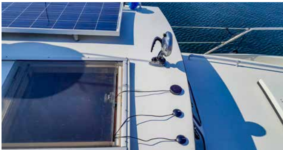
Den större pucken Locosys, de mindre Bu353N5 GNSS och Bu353S4 GPS
